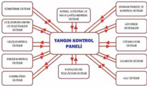
Şekil-2: Yangın Kontrol Paneli İşlevleri
